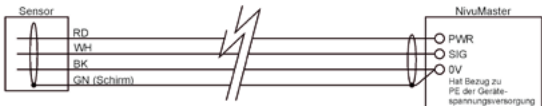
Abb. 19-8 Zuleitung ohne Überspannungsschutz
