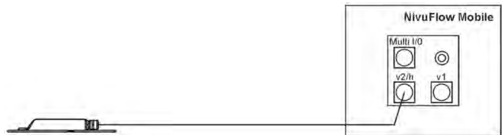
Abb. 26-3 Anschluss 2ter Fließgeschwindigkeitssensor CSM bzw. CSP (bei Verwendung kein Füllstandssensor DSM-L0 anschließbar)
