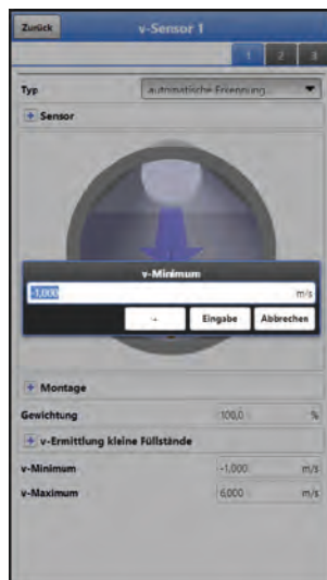
Abb. 40-24 Begrenzung der Geschwindigkeitsauswertung
