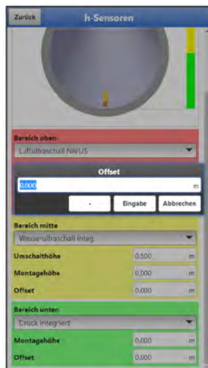
Abb. 40-13 Parametrierung des integrierten Drucksensors
