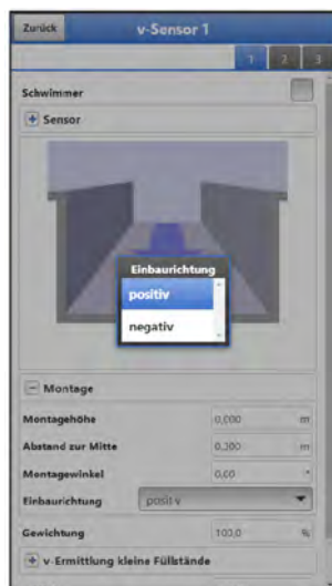
Abb. 40-20 Änderungsmöglichkeit Einbaurichtung Sensor
