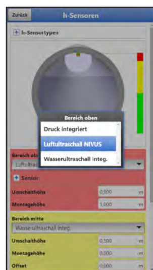
Abb. 40-12 Zuordnung Füllstandssensor zum Parametrierbereich
