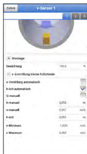
Abb. 40-22 Untermenü: v-Ermittlung kleine Füllstände
