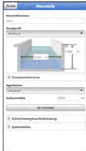
Abb. 40-3 Beispiel für ein Menü des Kanalprofils
