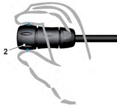
Abb. 25-2 Drehen des vorderen Ringes der Stecker (10polig/18polig)
