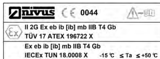
Abb. 17-2 Typenschild (Teil 2, nur bei Ex-Geräten) NivuFlow Mobile 750
