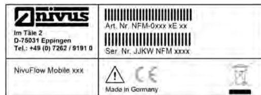
Abb. 17-1 Typenschild (Teil 1) NivuFlow Mobile 750 (Beispiel Ex-Gerät)
