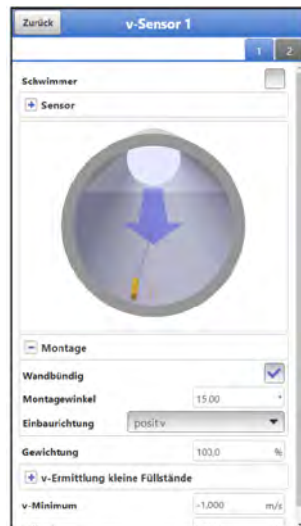
Abb. 40-16 Parametrierung durch Winkeleingabe
