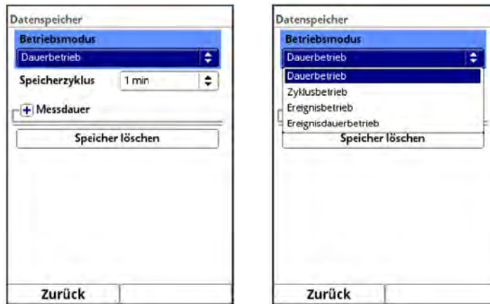
Abb. 35-10 Datenspeicher Zyklusbetrieb / Taktsteuerung
