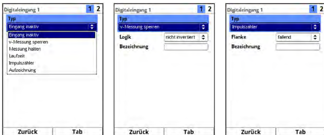
Abb. 34-24 Digitaleingänge: Aktivierung / v-Messung sperren / Impulszähler
