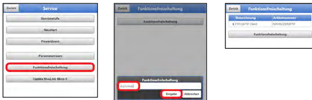
Abb. 41-9 Freischaltung der Lizenz im Anzeigetool des NLG02
