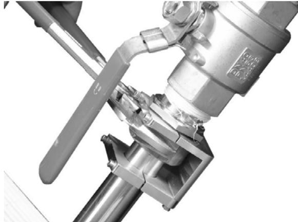
2. Die beiden Innensechskantschrauben am hinteren, oberen Klammerelement des Befestigungselementes lösen.
