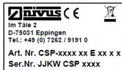
Abb. 4-40 Typenschilder für Sensor CSP
