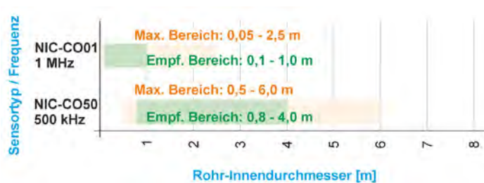
Abb. 18-3 NIC-CO (Clamp-On Sensor) und passende Rohr-Innendurchmesser
