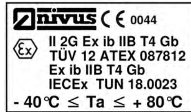
Abb. 16-2 Ex-Typenschilder Fließgeschwindigkeitssensor Typ NIS-V2 (zusätzlich)
