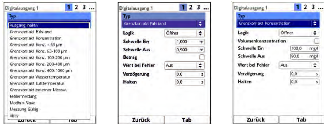
Abb. 37-20 Auswahl Digitalausgang / Grenzkontakt Füllstand / Grenzkontakt Konzentration
