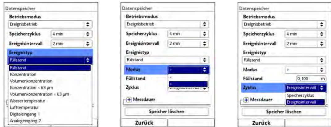
Abb. 38-7 Ereignis(dauer)betrieb: Ereignistyp / Modus / Zyklus
