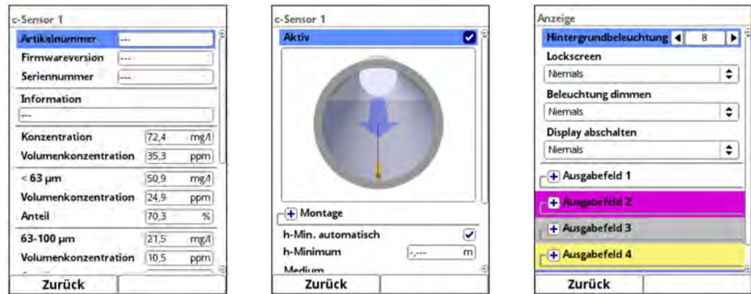
Abb. 30-1 Partikelkonzentration < 63 µm (mg/l): Pop-up-Menü und Menüseiten
