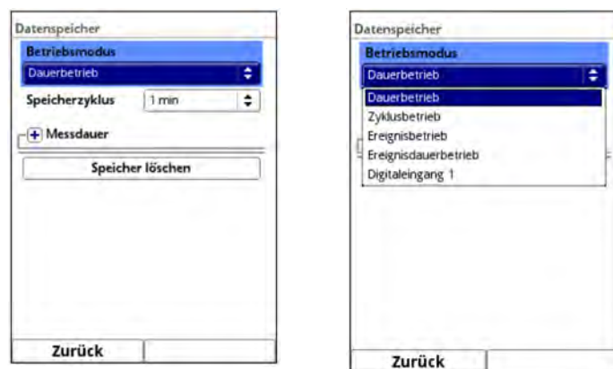
Abb. 38-5 Datenspeicher Zyklusbetrieb / Taktsteuerung
