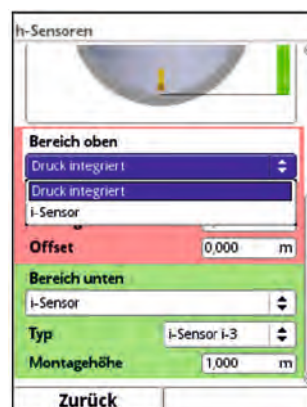
Abb. 37-7 Zuordnung Füllstandssensor zum Parametrierbereich
