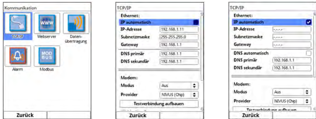
Abb. 40-1 Kommunikation / TCP/IP (Bilder mit Modem abgebildet)
