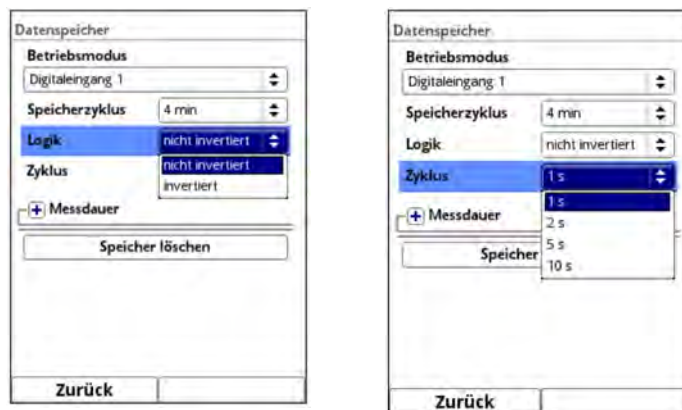
Abb. 38-6 Betriebsmodus Digitaleingang 1: Logik / Zyklus
