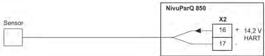
Abb. 24-6 Anschluss 2-Leiter-Sensor zur Füllstandmessung
