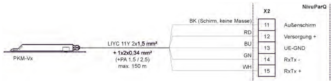
Abb. 24-4 Anschluss Partikelkonzentrationssensor an NP850 Typ S2/G2
