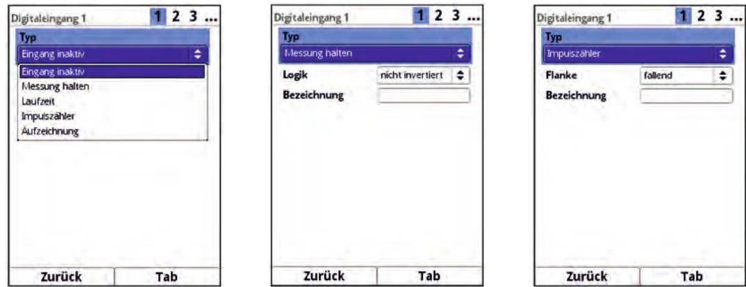
Abb. 37-19 Aktivierung Digitaleingang / Messung halten / Impulszähler
