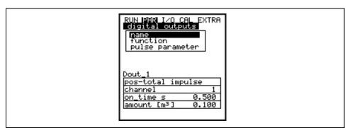
Fig. 8-45 Setting impulse parameters
