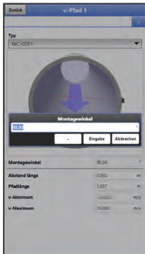
**Abb. 33-4 Montagewinkel (Clamp-On) eintragen**
