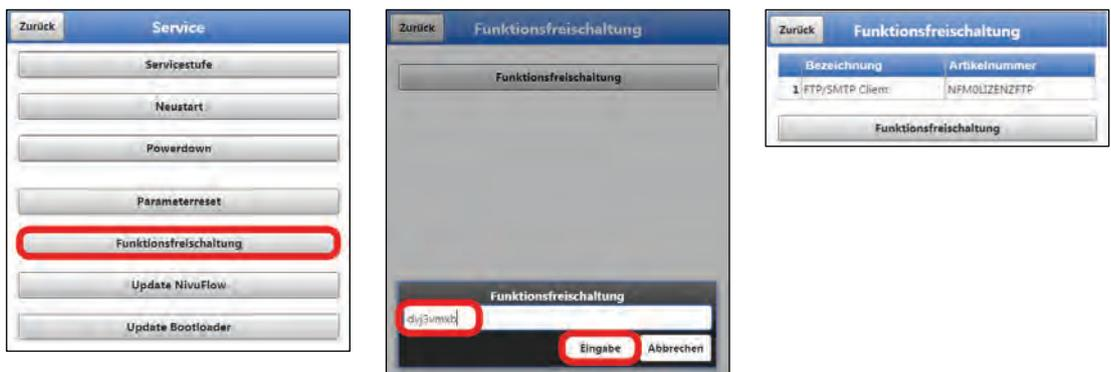
**Abb. 40-10 Freischaltung der Lizenz im Anzeigetool des NFM**
