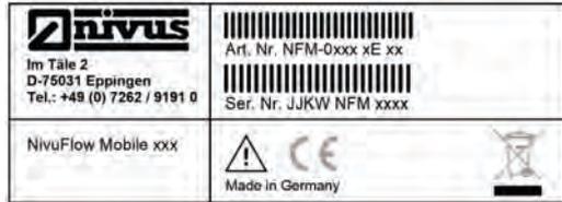
Abb. 17-1 Typenschild NivuFlow Mobile 600 (Beispiel Ex-Gerät)
