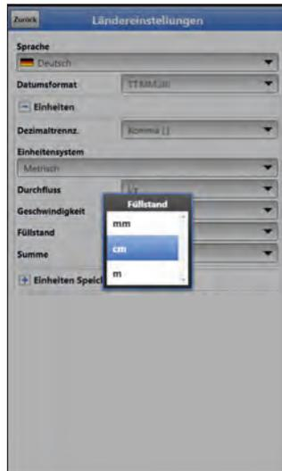
**Abb. 38-4** Einstellung der Maßeinheiten
