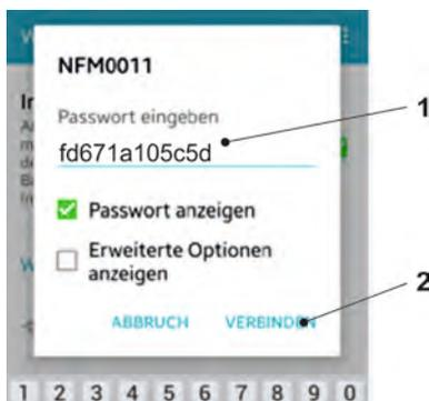
**Abb. 31-5 Passwort (hier fd671a105c5d als Beispiel) eingeben und verbinden**
