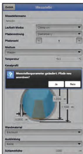
**Abb. 33-3 Geänderte Messstellenparameter übernehmen**
