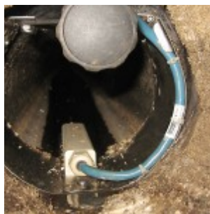
Wasser-Ultraschall und hydrostatische Messung z.B. für Niederschlagsabflussmessungen
