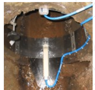
Luft-Ultraschall, Wasser-Ultraschall und hydrostatische Messung – zur Erfassung des gesamten Abflussbereiches z.B. zur Ermittlung der Kanalauslastung
