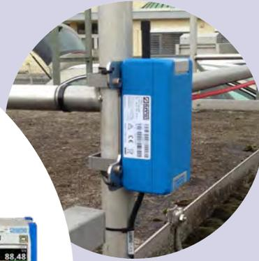
1. NivuFlow Mobile Messumformer mit Mobilfunkdatenübertragung
