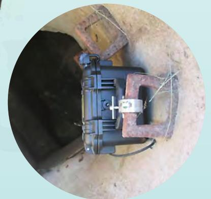
NivuLevel Mobile Messumformer mit Mobilfunkdatenübertragung
