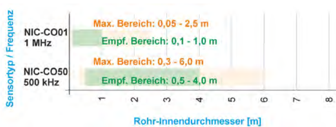
Abb. 18-3 NIC-CO (Clamp-On Sensor) und passende Rohr-Innendurchmesser
