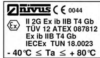
Abb. 16-2 Ex-Typenschilder Fließgeschwindigkeitssensor Typ NIS-V2 (zusätzlich)
