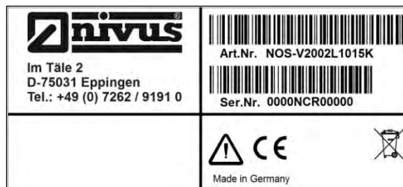
Abb. 16-1 Typenschild Fließgeschwindigkeitssensor ohne Ex (Beispiel Typ NOS)
