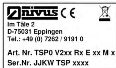
Abb. 16-4 Ex-Typenschilder Fließgeschwindigkeitssensor Typ TSP0 (zusätzlich)
