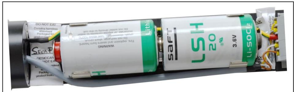
**Abb. 6-3 Einlegen der Lithiumbatterien**
