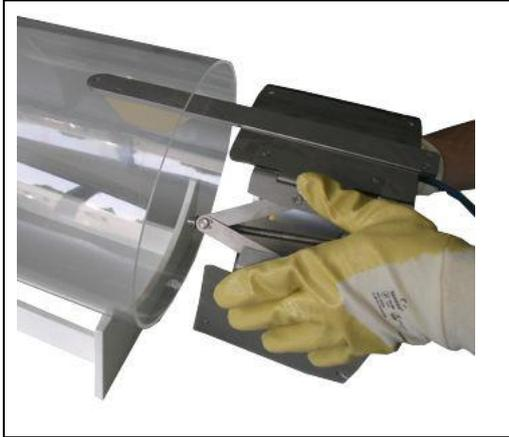
Gesamtes Rohrmontagesystem in das Rohr einführen und ausrichten.
