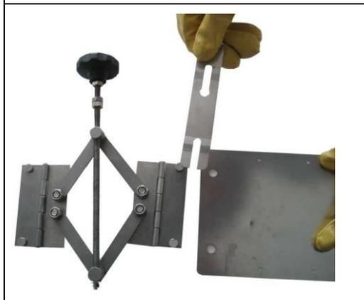
Spannvorrichtung auf beiden Seiten mit Spannklemmen an den Verlängerungsblechen befestigen.
