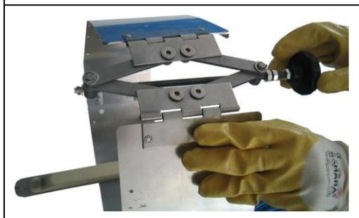
Vor dem Montieren im Kanal die Spannvorrichtung im Uhrzeigersinn ganz zudrehen.
