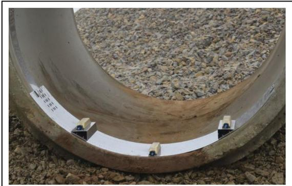
Spannbleche montiert mit CS2-Sensoren
