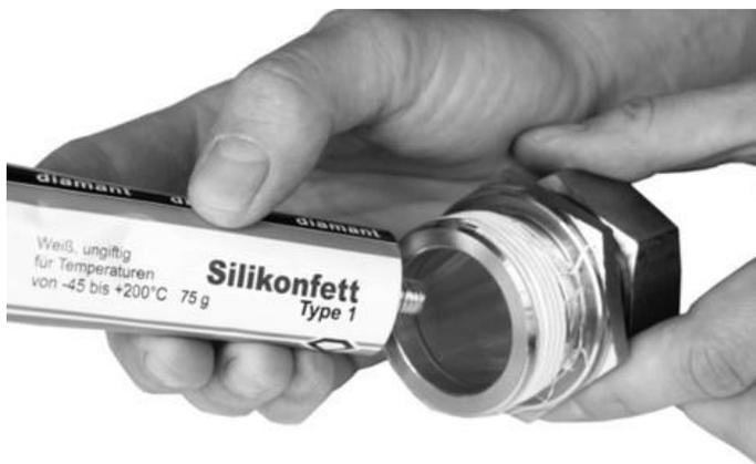
**Fig. 12-30 Graissage du raccord fileté capteur**
