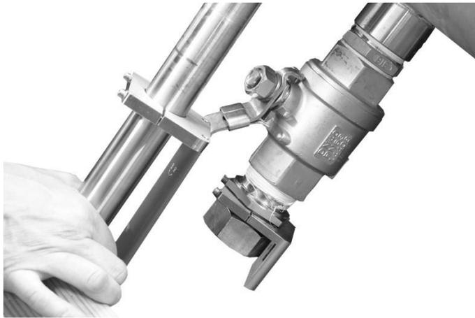
**Fig. 12-38 Retirez le capteur pour nettoyage et contrôle**
