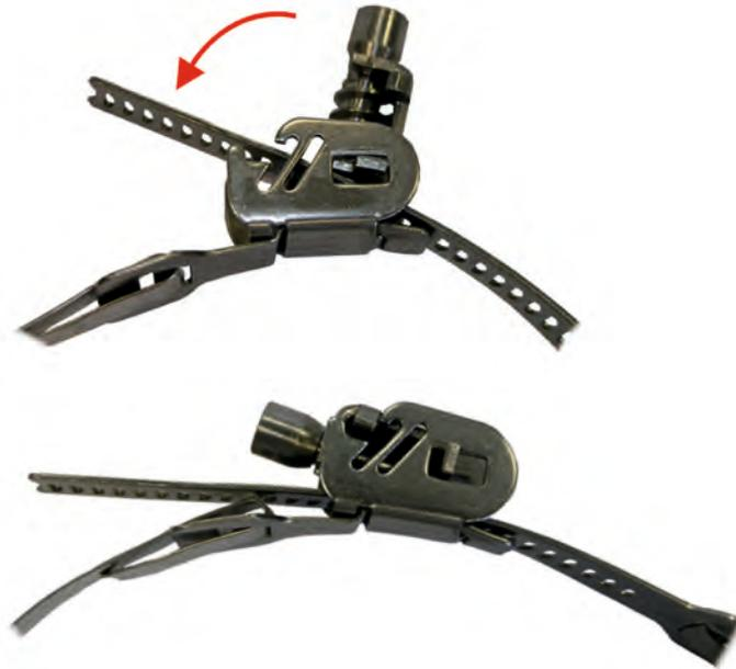
**Fig. 12-55 Introduire la sangle de serrage et fermez le tendeur**
