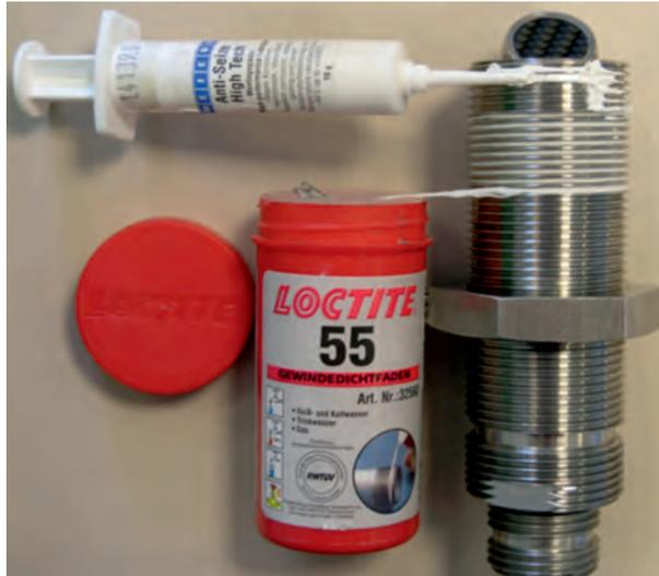
**Fig. 12-45 Préparation pour le montage de capteurs à visser**
