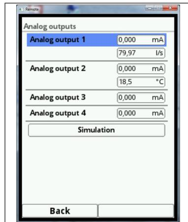
Fig. 7-93 Displayed analog output values
