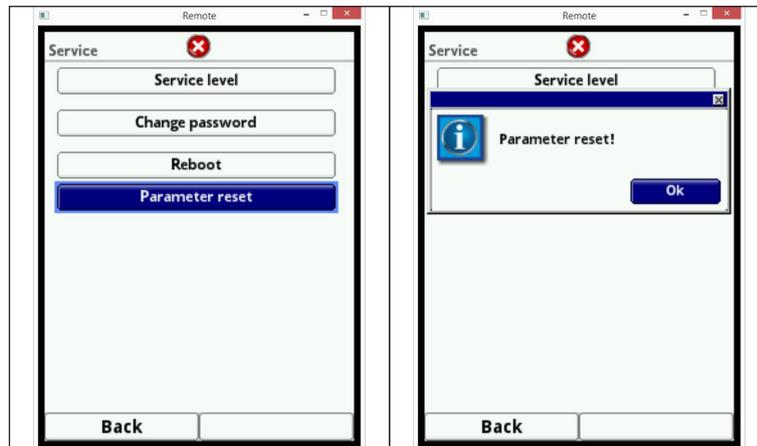
Fig. 7-156 Reset the parameters to default values
