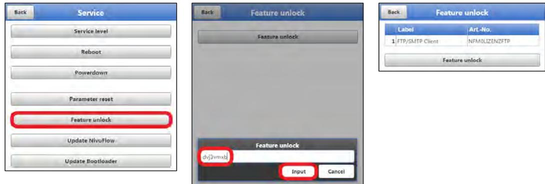
**Fig. 40-10 Activation de la licence dans module d'affichage du NFM**
