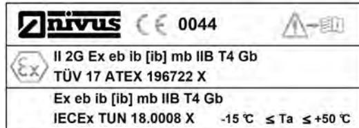
Fig.17-2 Étiquette d'identification Ex NivuFlow Mobile 550 (supplémentaire)
