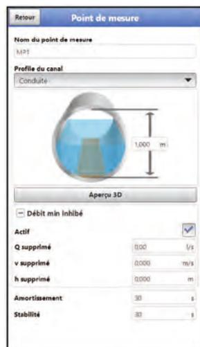
**Fig. 38-6 Suppression des débits inhibés**
