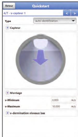
Fig. 44-4 v-capteur 1
