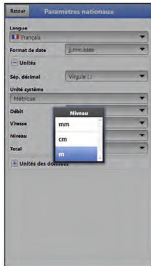
**Fig. 38-3 Réglage des unités de mesure**
