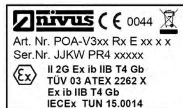
Fig. 4-44 Plaques signalétiques Ex pour capteur POA-V2/V3 (en plus de la plaque signalétique)
