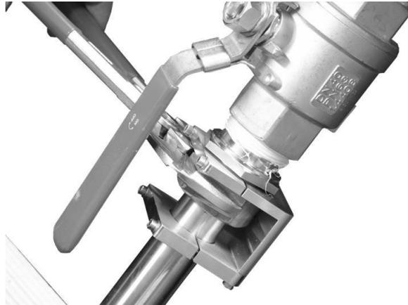
2. Desserrer les deux vis à six pans creux situées à l'arrière, dans l'élément de serrage supérieur de la fixation.
