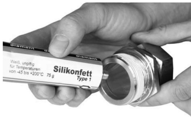
2. Visser le raccord capteur dans le manchon soudé ou dans la vanne d'isolement.
