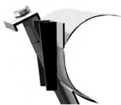
→ Le serrage de l'écrou emboîte le support de fixation dans le support latéral.
