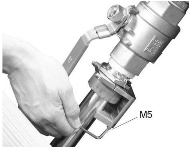
3. À l'aide des deux vis à six pans creux (Allen®) M5 (voir *Fig. 5-28*, pos. 8), visser l'élément de serrage inférieur arrière (pos. 7) sur l'élément de serrage supérieur arrière (pos. 2).
