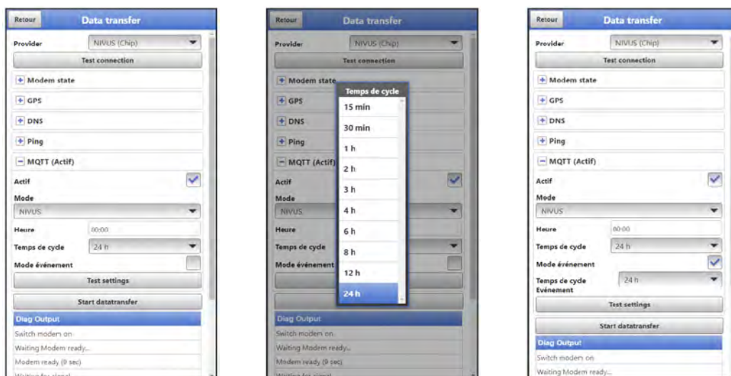
Fig. 42-5 MQTT actif / temps de cycle / mode événement
