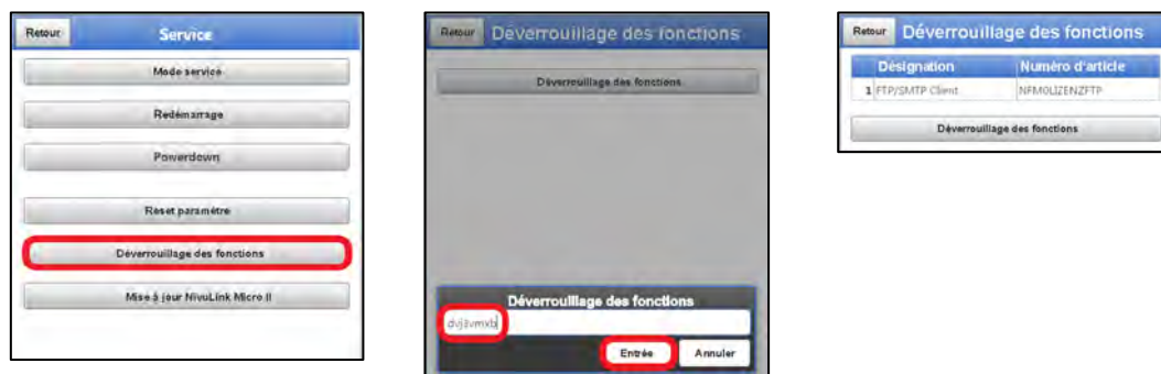
Fig. 41-9 Activation de la licence dans le module d'affichage du NLG02
