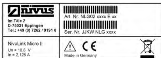
Fig. 18-1 Plaquette signalétique (partie 1) NivuLink Micro II (exemple appareil Ex)
