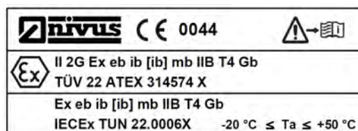
Fig. 18-2 Plaquette signalétique (partie 2, uniquement pour appareils Ex) NivuLink Micro II Ex
