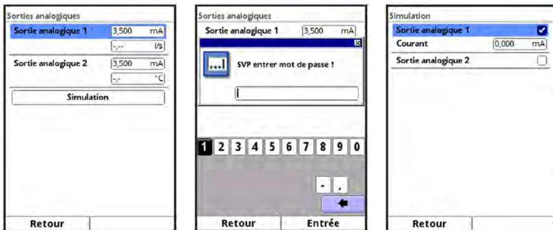
Fig. 40-3 Affichage des valeurs de sortie analogiques
