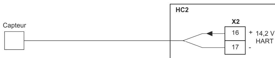
Fig. 23-1 Raccordement d'un capteur 2 fils (HART) pour une mesure de niveau à l'entrée analogique 1
