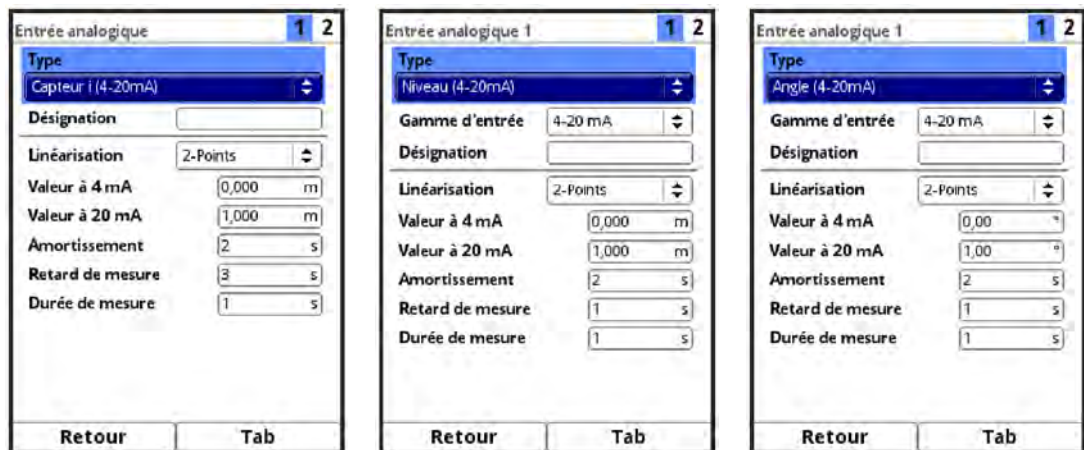
Fig. 34-15 Capteur i (4-20mA) / Niveau (4-20mA) / Angle (4-20mA)
