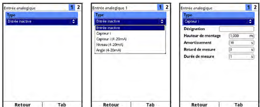
Fig. 34-14 Activation des entrées analogiques /
