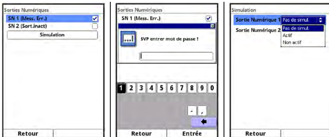
Fig. 40-5 Affichage des sorties numériques
