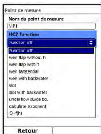
Fig. 34-2 Fonctions HC2 / fonctions de calcul sélectionnables
