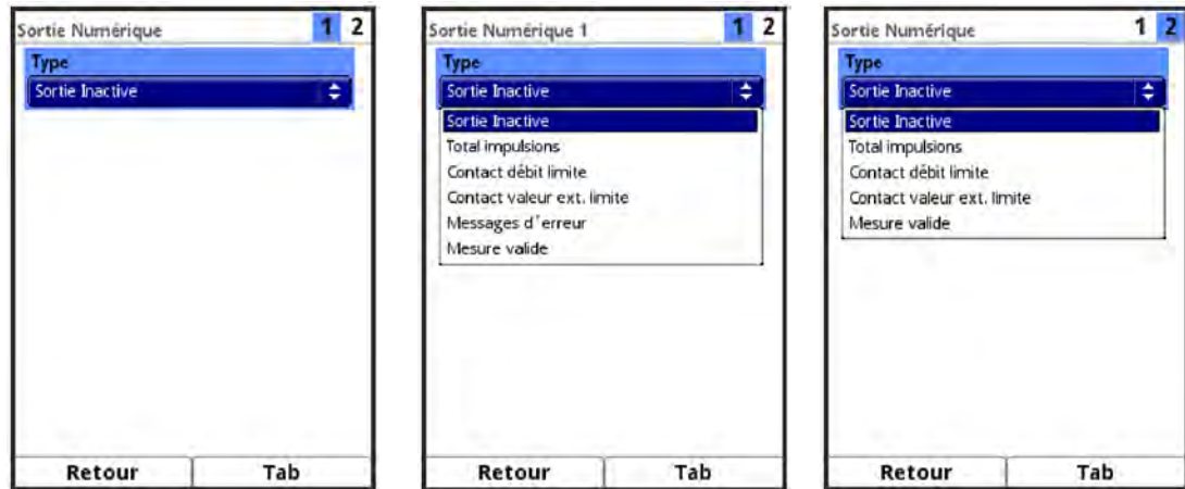
Fig. 34-20 Activation des sorties numériques
