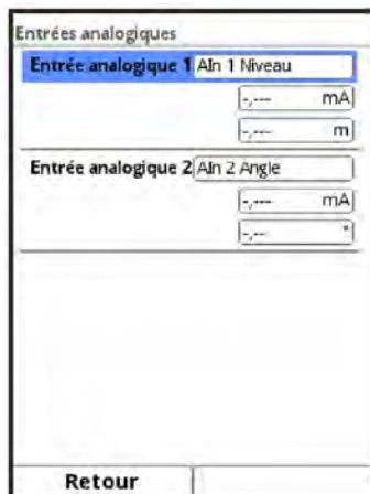
Fig. 40-2 Affichage des valeurs d'entrée analogiques
