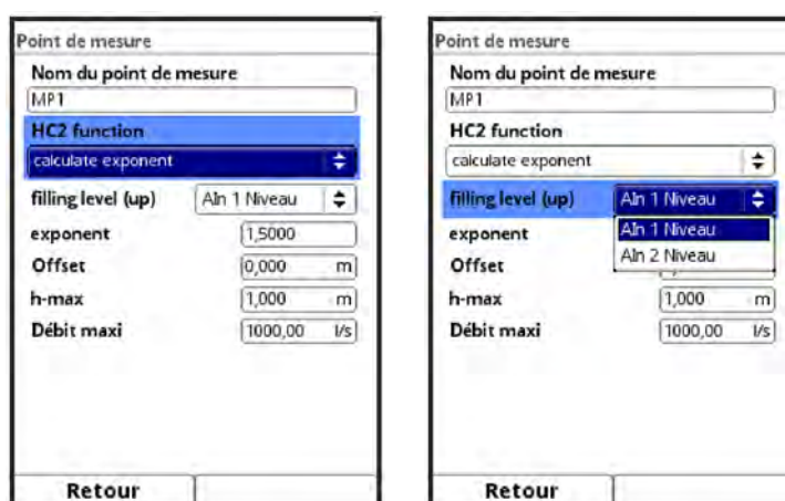
Fig. 34-11 Paramétrage du calcul exponentiel
