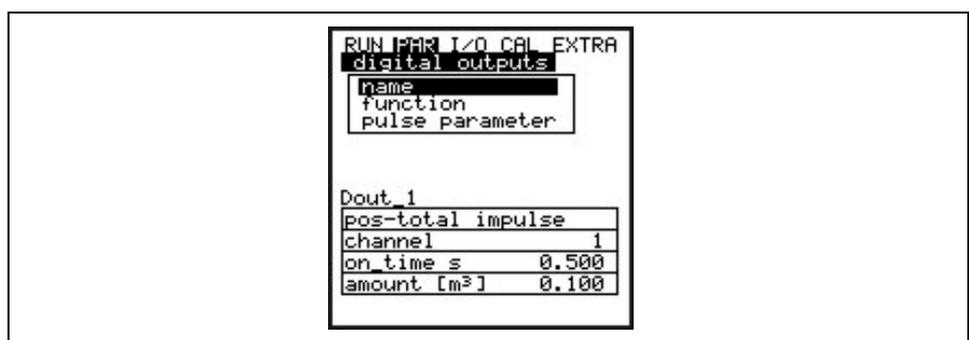
Fig. 8-45 Setting impulse parameters
