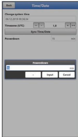
**Fig. 33-5 Set Energy Saving Mode/Powerdown**
