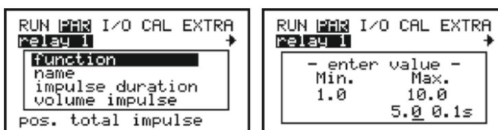
Fig. 23-30 Submenu impulse
