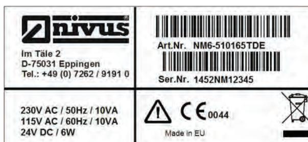
Abb. 15-1 Typenschild der NivuMaster Serie
