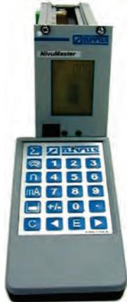
**Abb. 25-1 19“-Gerät mit Handprogrammer**
