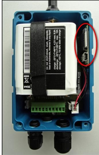
Bild 5 Gesamtsystem mit integriertem Modem und gesteckter SIM-Karte
