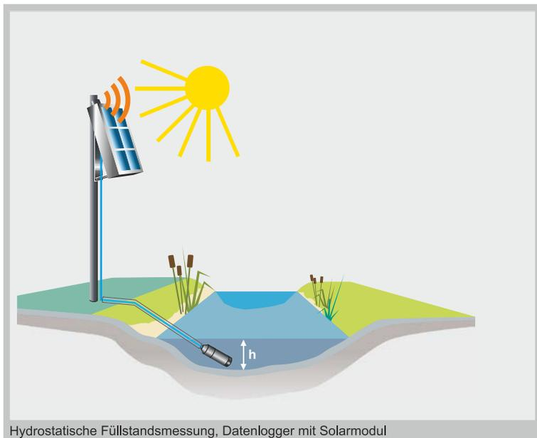
Bild 2 Exemplarische Darstellung eines robusten Solarsystems mit GPRS Datenübertragung
