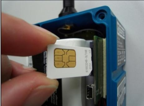
Bild 4 SIM-Karteneinschub am Modem
