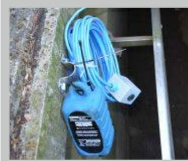
Becken mit montiertem Füllstandssensor und Datenlogger
