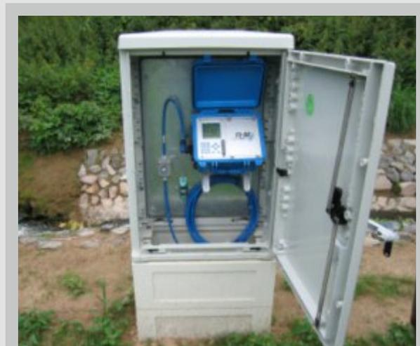
Geöffneter Schaltschrank mit Messumformer
