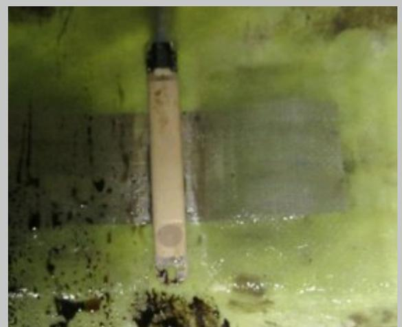
*Montierter CS2-Sensor (Kombisensor)*
