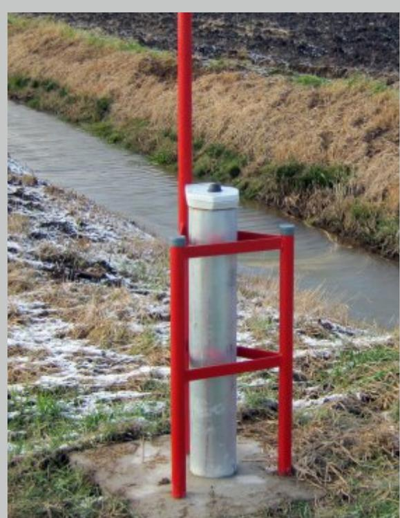
*Pegelrohr mit Mastkappe und Kuppelantenne*
