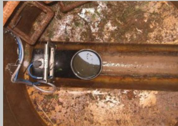
Temporär im Kanal eingesetztes Messsystem
