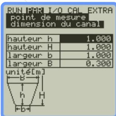
Le profil du canal peut être visualisé directement sur l'appareil
