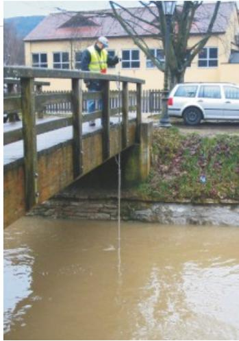
**Mesure de débit avec le NivuChannel dans un cours d'eau à faible écoulement.**
