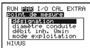
Fig. 29-2 Sous-menu – point de mesure
