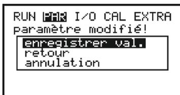
**Fig. 26-1** Aperçu fin de programmation/possibilité de sauvegarde
