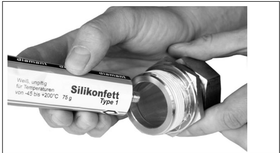
Fig. 4-29 Graissage du raccord fileté capteur
