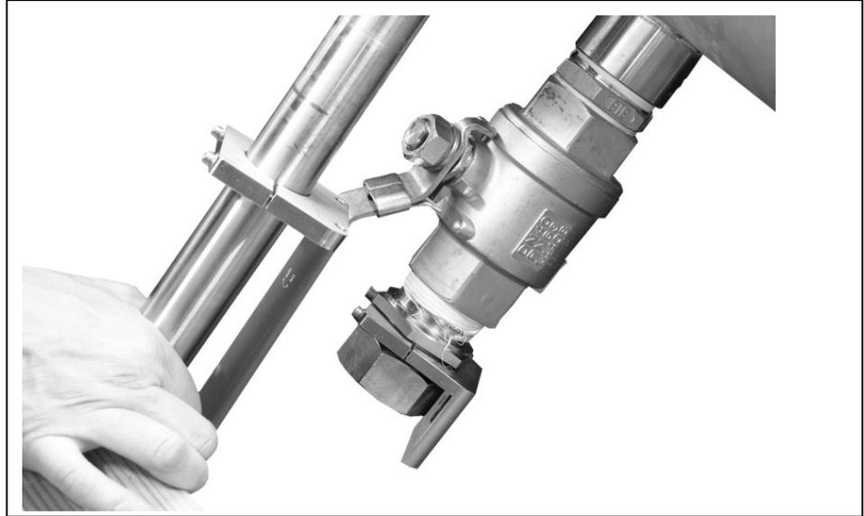
**Fig. 4-37** Dégagez le capteur (nettoyage /contrôle)
