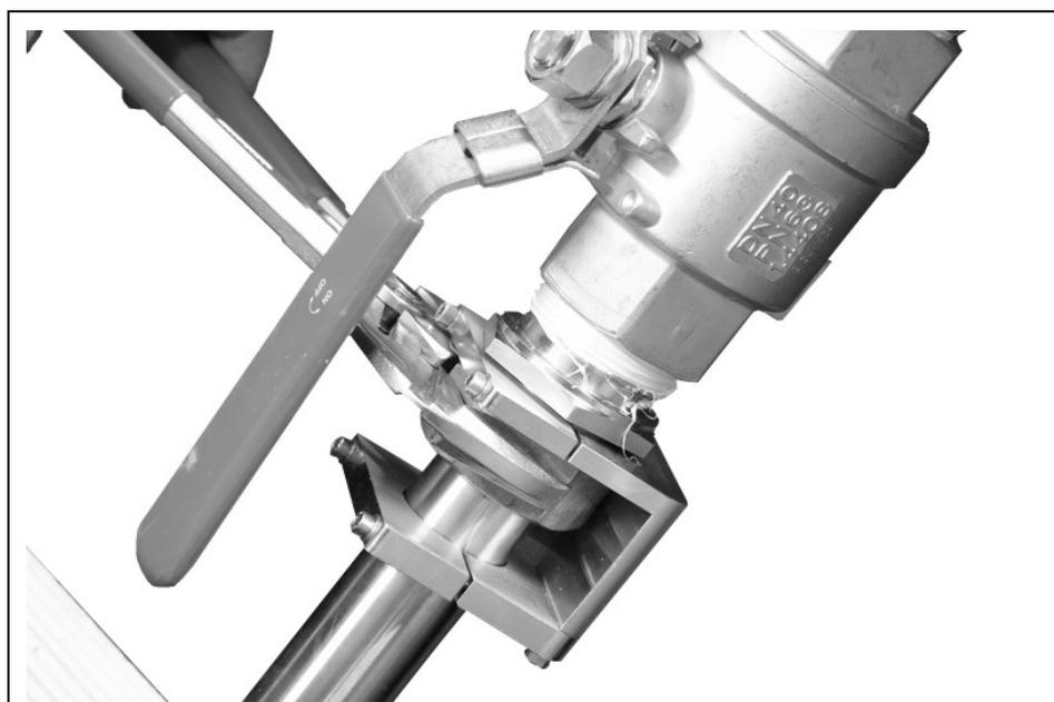
**Fig. 4-36** Desserrage pour dégagement du capteur
