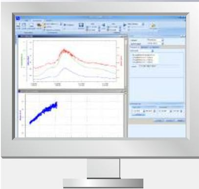
NivuSoft est un logiciel dont les fonctions sont parfaitement harmonisées au traitement des données de mesure dans le domaine de la gestion de l'eau.
