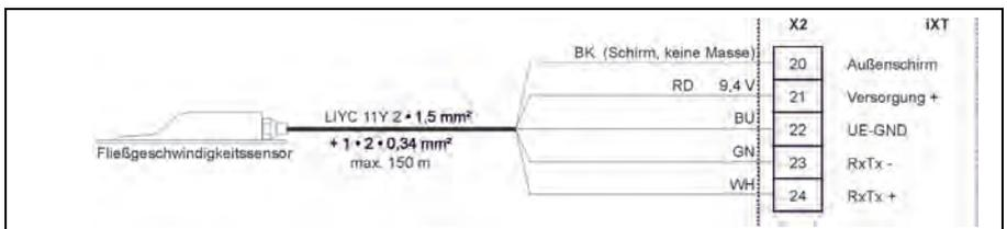
**Abb. 22-12** Dritter Fließgeschwindigkeitssensor an iXT04xx (nur bei NivuFlow)
