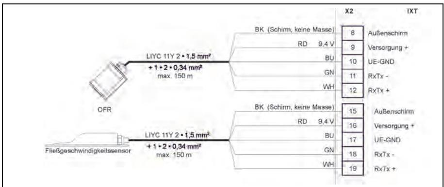
**Abb. 22-16 Radar- und Kreuzkorrelations-Fließgeschwindigkeitssensor an iXT04xx (nur bei NivuFlow 7550)**
