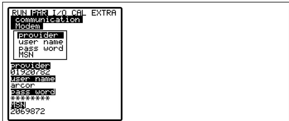
Fig. 9-118 GPRS modem parameter settings
