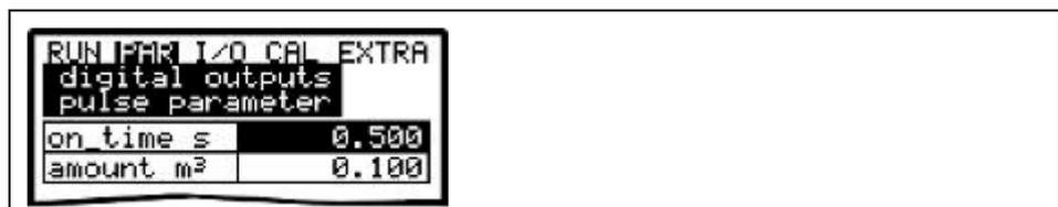
Fig. 9-75 Pulse parameter setting
