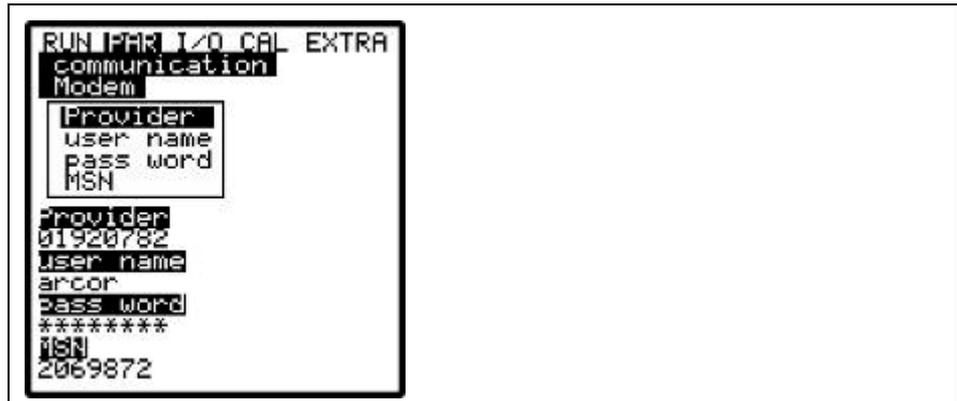
Fig. 9-117 ISDN modem parameter settings
