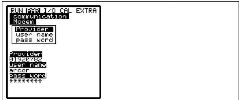
Fig. 9-116 Setting analog modem parameters
