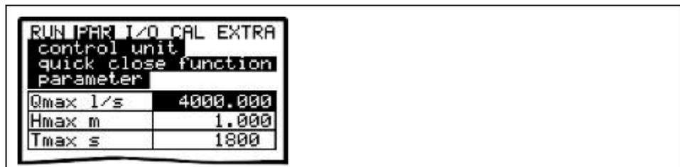
Fig. 9-88 Quick close parameters
