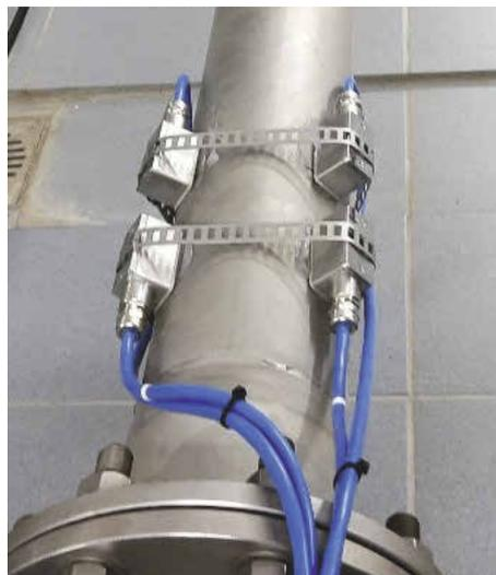
**Ist es nicht möglich, die Sensoren in den Prozess einzubringen, können diese von außen an die Rohrleitung angebracht werden**
