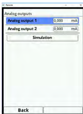
Fig. 32-3 Screen analog output values
